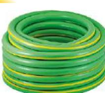
Изготовлен из высококачественного сырья с использованием прочной армированной нити. Используется для поливочных работ. Рабочее давление 6 бар для Ø1/2", и 4 бар для Ø3/4". Толщина стенки: 1,8 мм +/- 0,2. Температурный режим эксплуатации: -10°C/+65°C.
